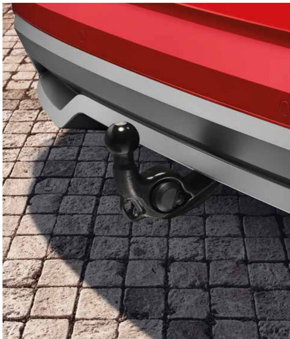
З'ємний фаркоп 658 092 160 | для авто з підготовкою під фаркоп 658 092 160 + 657 055 204 | для авто без підготовки під фаркоп
